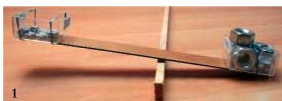
Si l'on rapproche le pivot de la charge, il devient alors possible de la soulever.
